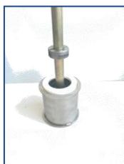
Le skimmer tubulaire en inox se fixe sur le support du bac par un simple trou de Ø 22 mm, avec la possibilité de régler la hauteur pour des différences de marnage de 80 mm, hauteur du bac mini : 100 mm.
