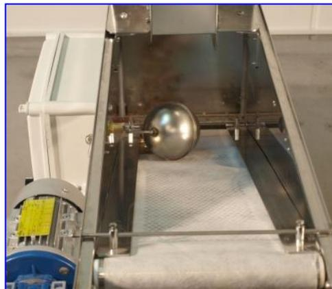
La chambre de filtration inclinée – le liquide est dirigé par le géotextile où sont retenues les particules non désirées.
