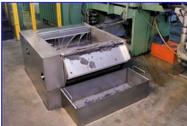
Système de filtre à papier utilisé comme un préfiltre dans le processus de traitement de l'eau. Ici les grandes quantités de particules sont enlevées, qui assure la plus longue durée sur les filtres de mesure fine.
